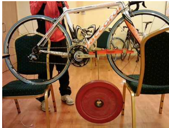
Figure 23 : Calibration statique du pédalier SRM pour contrôler « la pente »
