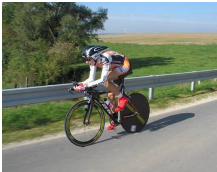
Un cycliste pendant un CLM où l'on peut observer une position aérodynamique, une roue lenticulaire, un cadre profilé, un guidon de triathlète...(www.ccetupes.fr)
